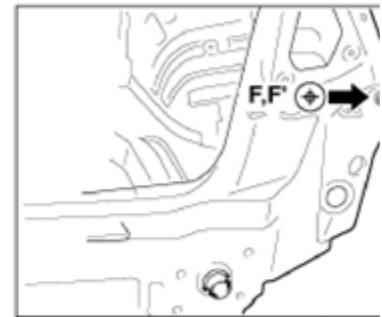
Tooling hole (ø8)
